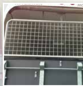
Fohlengitter für alle CL 2 er Pferdeanhänger mit einer Innenbreite von 167 cm
